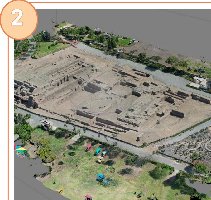
2 Las imágenes capturadas son procesadas por un software especializado que aplica la fotogrametría para construir un modelo digital en 3 dimensiones con precisión milimétrica y calidad fotográfica.
