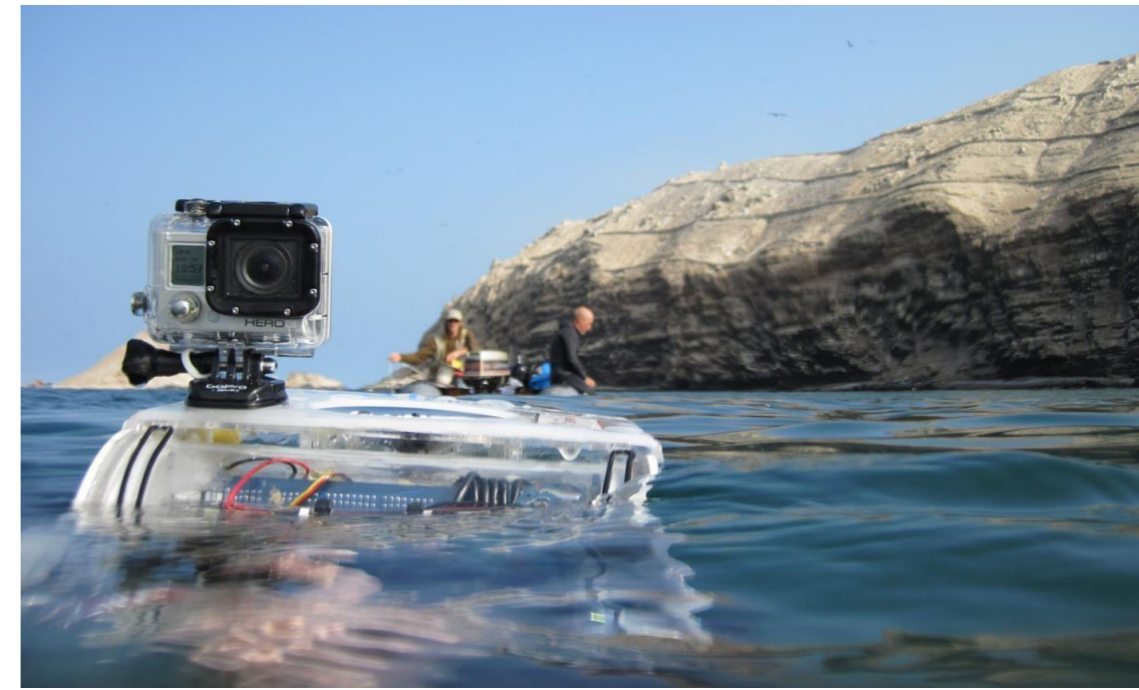
Vehículo de operación remota (ROV) instrumento de apoyo en prospección y registro subacuático (Archivo: MSPAC)
