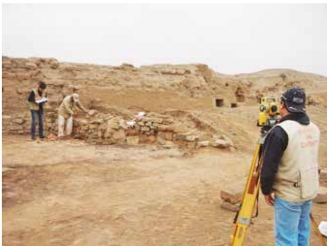
Figura 4. *Proceso de georeferenciación con estación total (Foto: Archivo MSPAC).*
